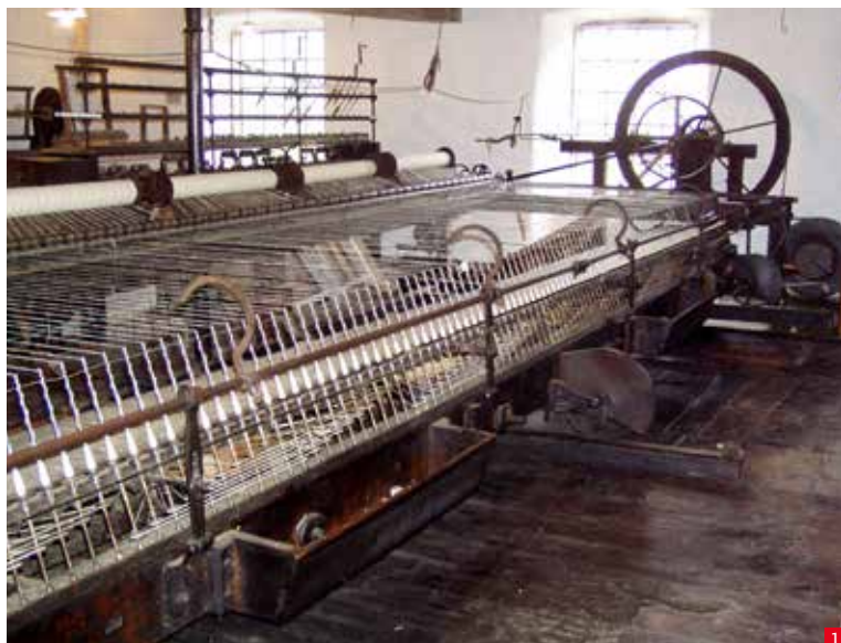
1 Mule jenny, musée de la Filature de Calquières à Langogne en Lozère. Cette Mule Jenny fut achetée en 1825 en Seine-Inférieure, et fonctionne encore. Photo Gilles Pichavant.
