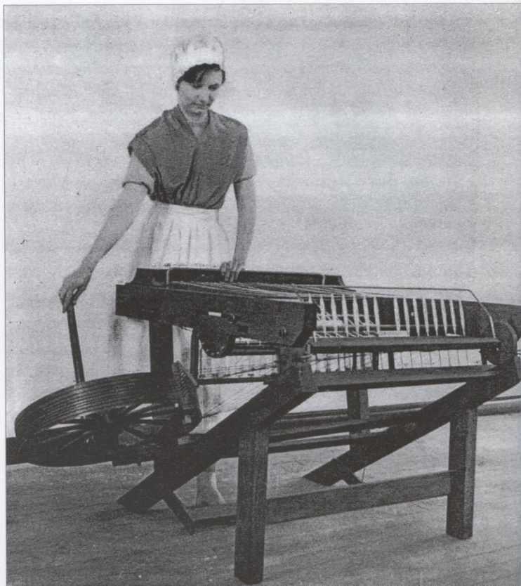
La fameuse « spinning-jenny », inventée en 1767 par l'anglais James Hargreaves, qui pouvait filer jusqu'à 48 fils à la fois
